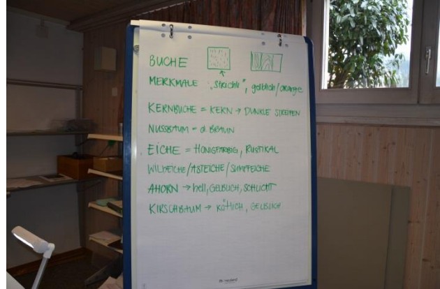
Die Referentin Nadine Schläpfer erarbeitet mit den Lernenden die Eigenschaften der gängigsten Holzarten.
